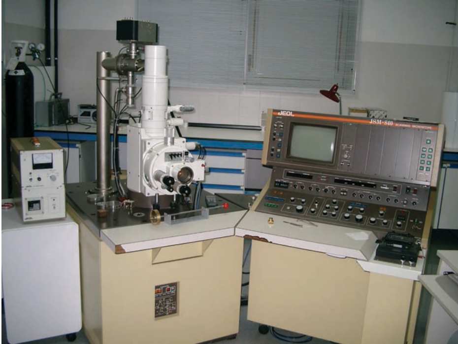
Figura 13. Imagen de un microscopio electrónico de barrido, herramienta habitual en los estudios palinológicos. Servicio Centralizado de Apoyo a la Investigación de la UMA.
