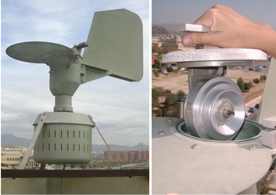
Figura 18. Captador volumétrico de tipo Hirst y detalle del mecanismo interior.
