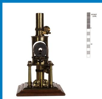
Galvanómetro de espejo móvil utilizado para comprobar el cable atlántico
