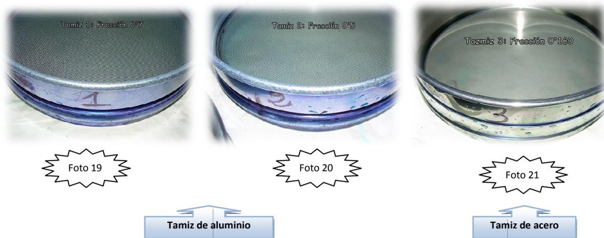
A continuación, con la mano se frota energicamente la muestra contra la malla y se procurará que vayan pasando de un tamiz a otro Fotos 22,23 y 24 los restos de la muestra. Es importante tener en cuenta que si cae muestra fuera del tamiz “nunca” se debe recoger, ni se volverá a introducir de nuevo dentro del tamiz, así se evitará que la muestra se contamine.
