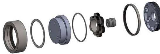
Figura 6.3: Vista explosionada de la reductora epicicloidial fabricada por Ingeniería Uno
