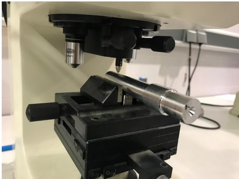
*Figura 3.39. Ensayos de microdureza Vickers*
