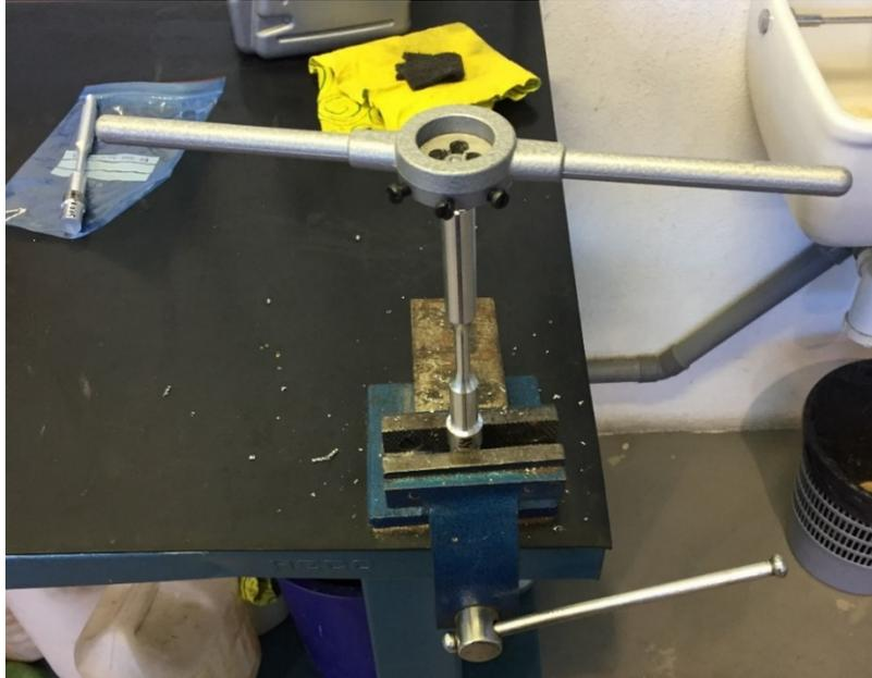
**Figura 3.23.** Preparación del roscado mediante terraja de roscar
