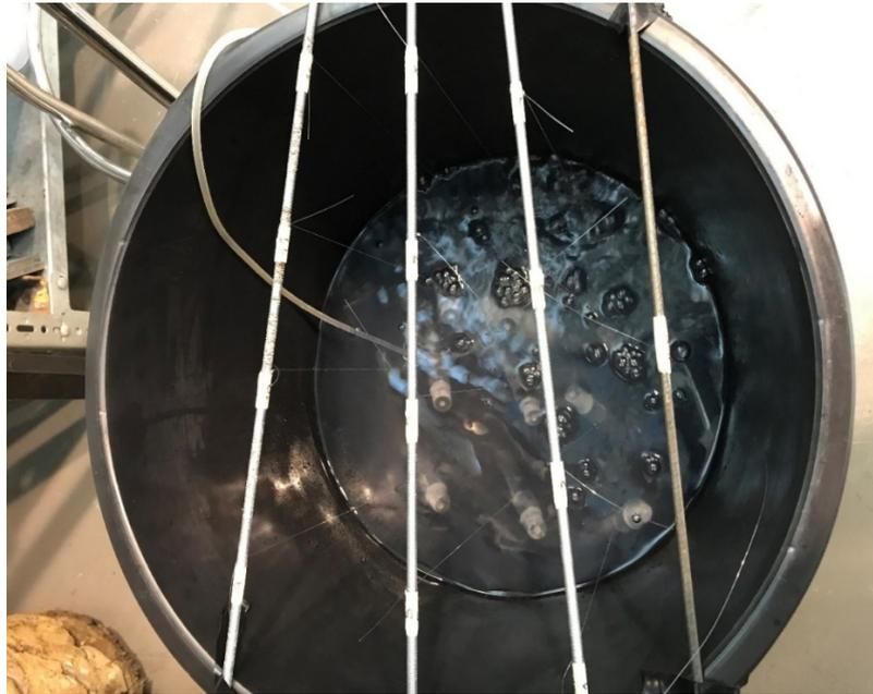
**Figura 3.44.** Inmersión de las muestras en solución salina
