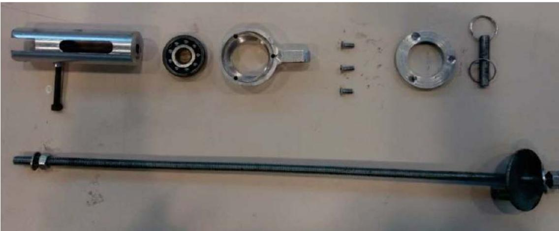
*Figura 3.56. Componentes del módulo de transmisión de carga*
