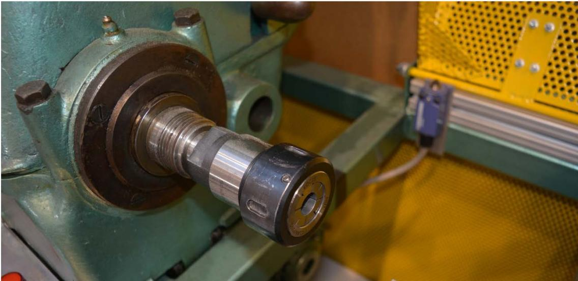
*Figura 3.55. Portapinzas para la sujeción de la probeta*
