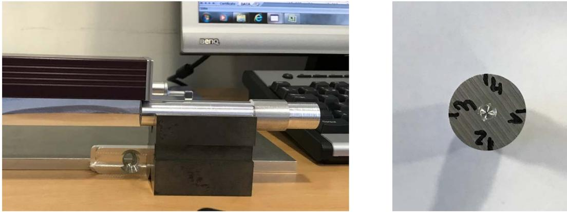
**Figura 3.29.** Medición de rugosidad superficial en probetas para ensayos de microdureza
