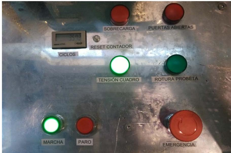
**Figura 3.62.** Cuadro de maniobra de la máquina de ensayos a fatiga
