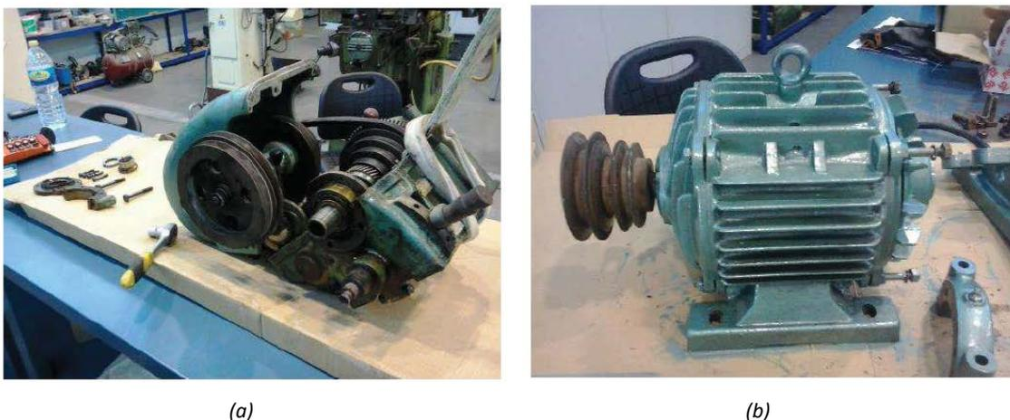
**Figura 3.53.** Elementos reutilizados de un torno Cumbre 022 (a) bloque cinemático, (b) motor eléctrico
