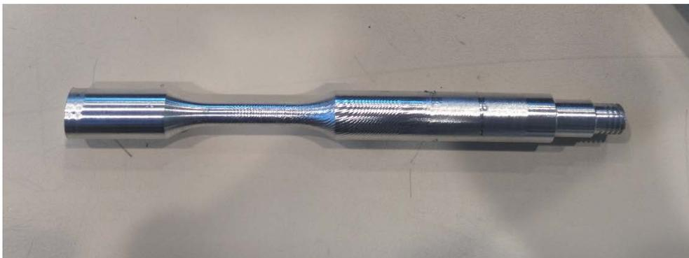
**Figura 3.24.** Probeta para ensayo a fatiga tras la operación de mecanizado
