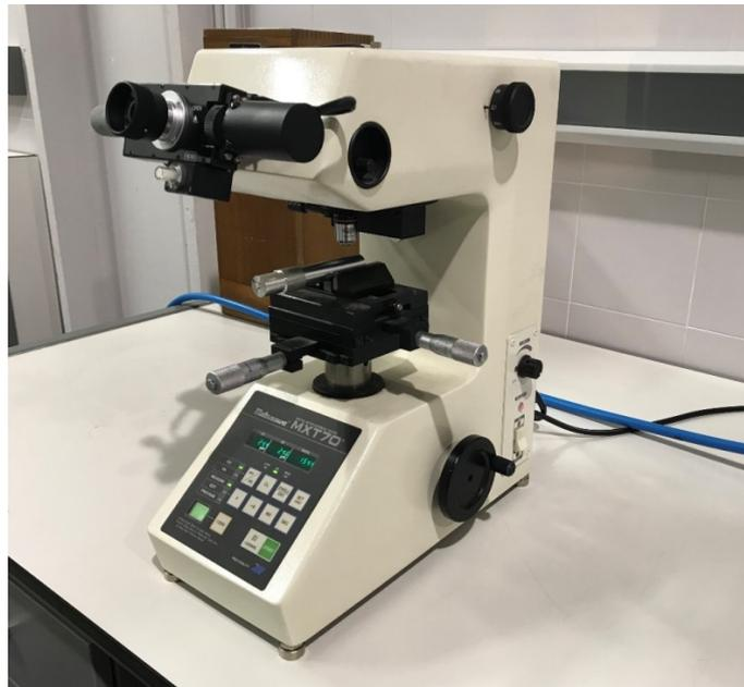
**Figura 3.38.** Microdurómetro MATSUZAWA, modelo MXT 70, para ensayos de microdureza superficial
