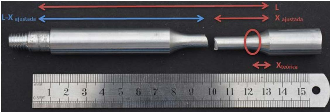
**Figura 4.72.** Probeta de fatiga con sección de rotura alejada de la sección estimada de rotura
