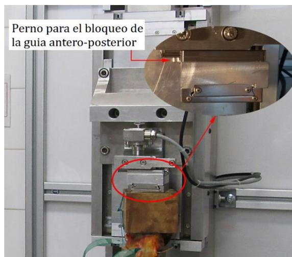
Figura C. 4 Detalle del bloqueo de la guía antero-posterior mediante perno, para estabilizar la rodilla.
