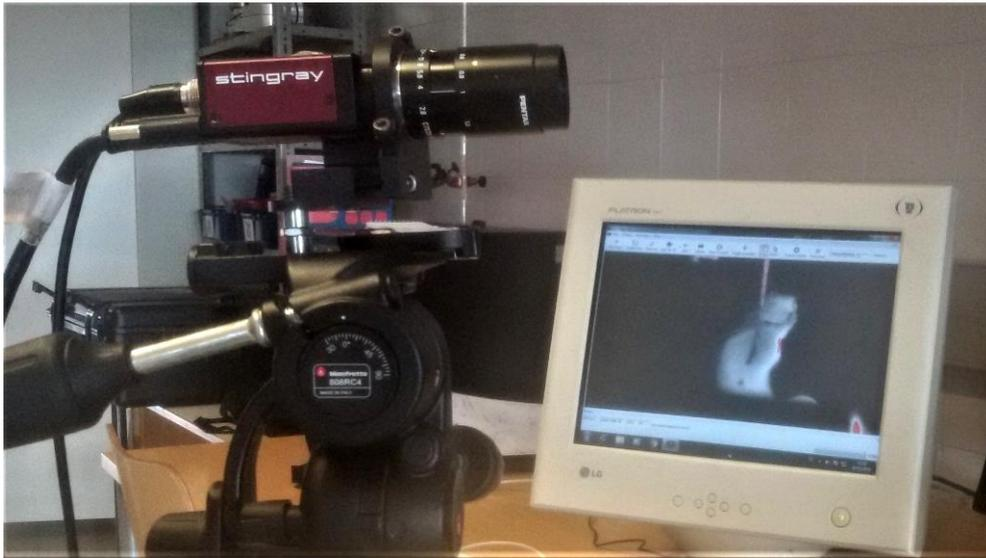
Figura 2.39. Sistema de captura de imágenes utilizado en los ensayos.
