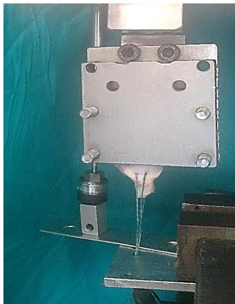
Figura 4.4. Especimen montado en la máquina de ensayo. Se aprecia la dirección de las suturas paralela a las fibras del ligamento de la raíz y a la dirección de carga.
