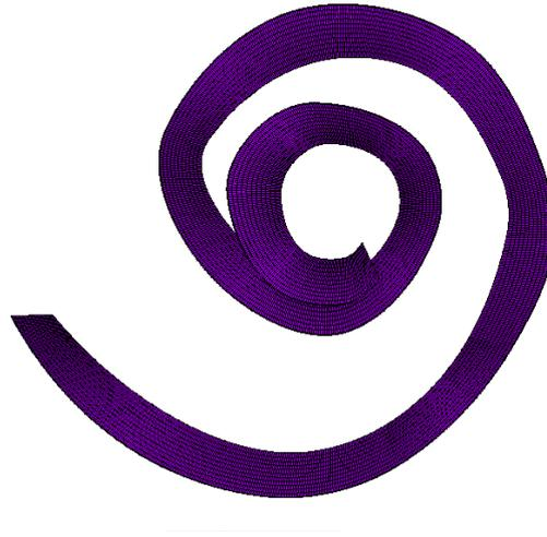
**Fig.3 24 Elementos Membrana de Reissner**
