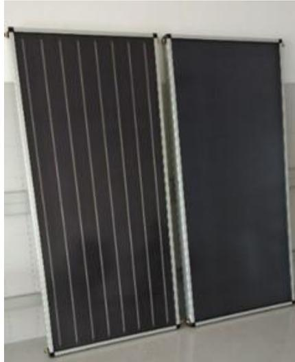
**Figura 3.14.** Captadores solares ensayados. Izquierda tipo parrilla, derecha, serpentín
