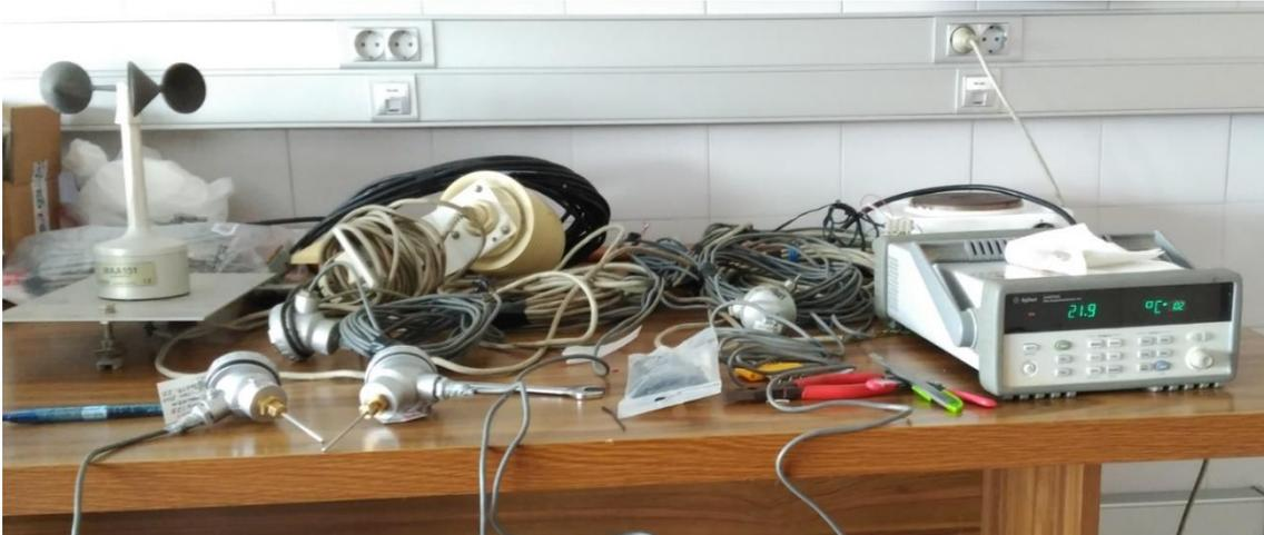
**Figura 3.13.** Sensores y cableado conectados para prueba de datalogger AGILENT 34970A
