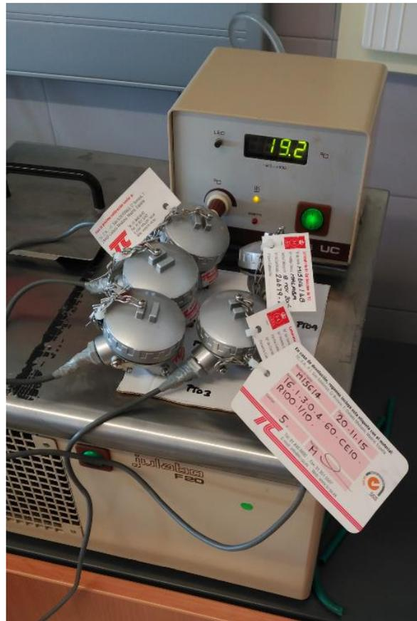
Figura 3.8. Calibración conjunta de sondas PT100 en baño de calibración JULABO F20
