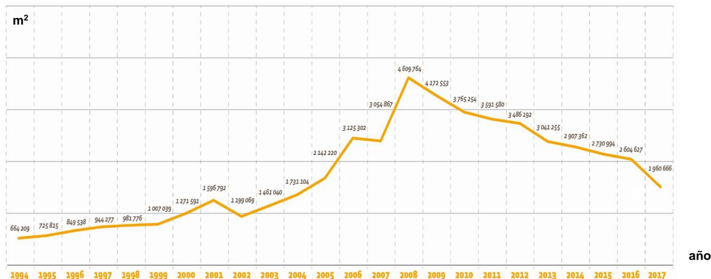
**Figura 1.3.** Evolución anual de la superficie de captadores solares instalada en la UE, en m<sup>2</sup>. Fuente: EurObserv'ER
