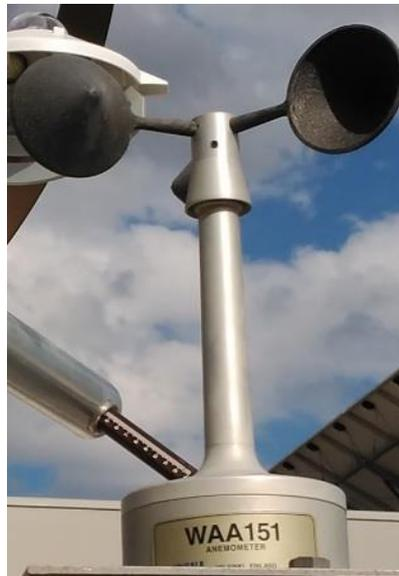
**Figura 3.12.** Anemómetro VAISALA WAA151
