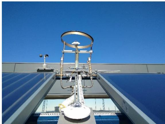
Figura 3.11. Piranómetros instalados. Superior con disco solar para medida de  $G_d$
