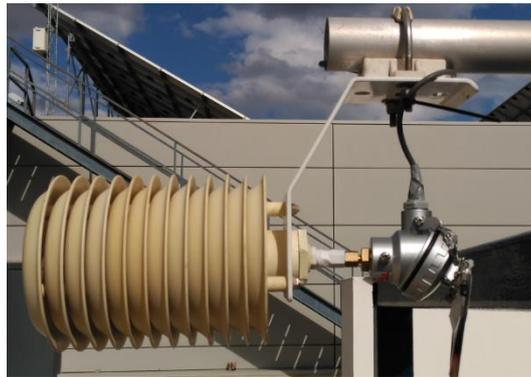
Figura 3.15. Ubicación de la sonda para medida de temperatura ambiente exterior
