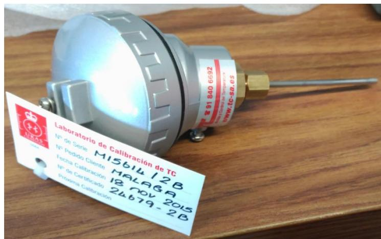
Figura 3.7. Sonda PT100 4 hilos clase 1/10
