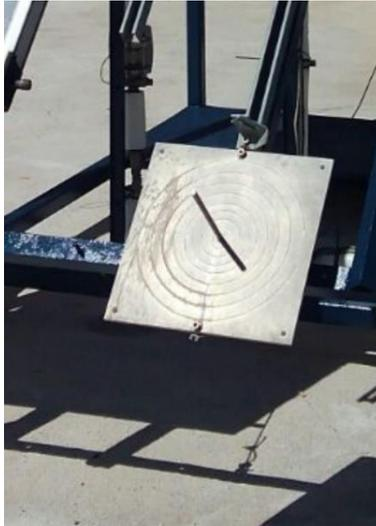
**Figura 3.2.** Puntero solar para la medición del ángulo de incidencia en plano de captación
