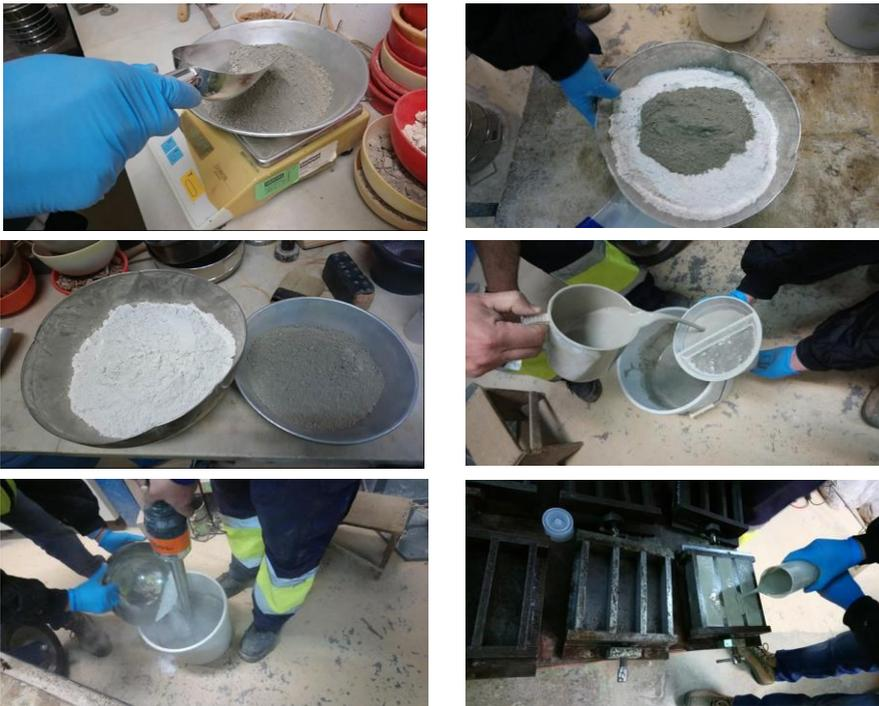
FIGURA 6. 2 PREPARACIÓN DE LAS PROBETAS LABORATORIO GEOCISA
