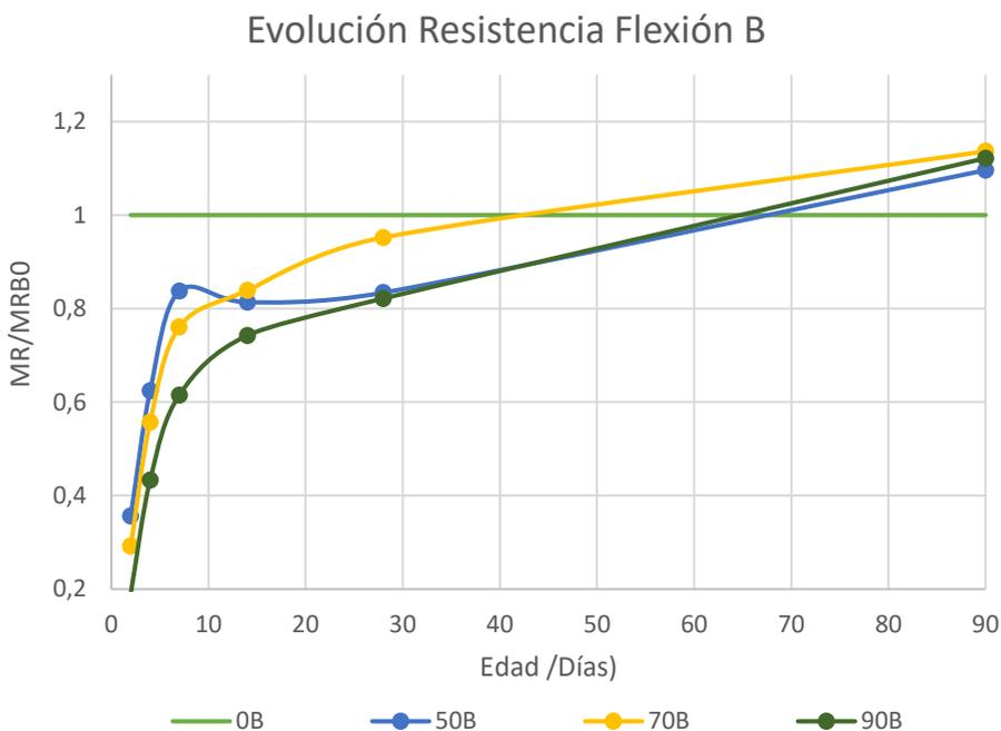
FIGURA 5. 21: EVOLUCIÓN DE LA RESISTENCIA A FLEXIÓN A LO LARGO DEL TIEMPO
