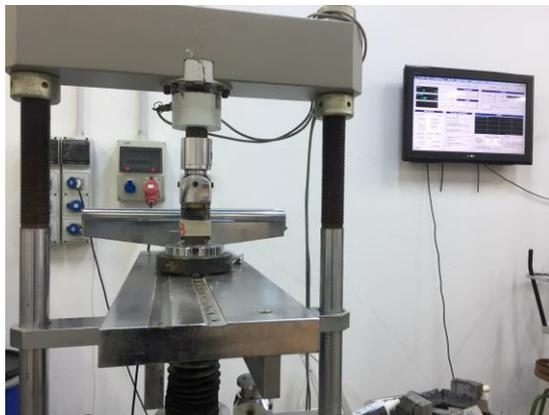
Figura 4. 11: Ensayos de rotura compresión
