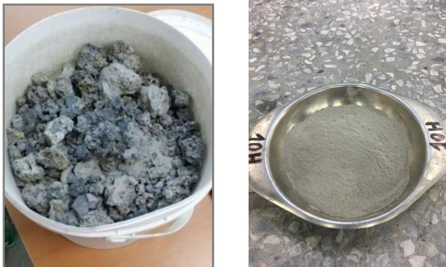
FIGURA 3. 7: MUESTRA ESCORIA LFS2 ANTES Y DESPUÉS DE TAMIZAR
