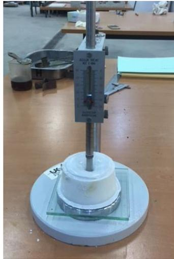
FIGURA 5. 14: ENSAYO DE CONSISTENCIA DE VICAT
