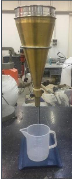
FIGURA 4. 2: CONO PARA EL ENSAYO DE FLUIDEZ
