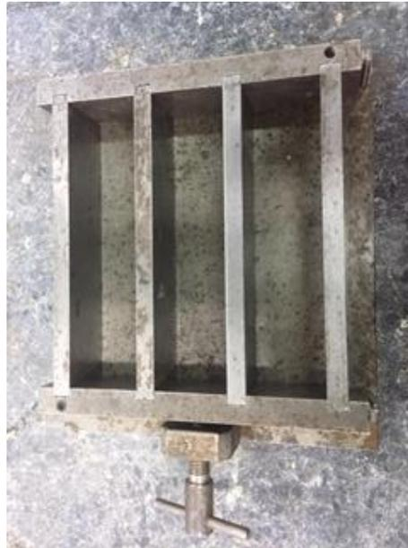
FIGURA 3. 8: MOLDE PRISMÁTICO DE ACERO
