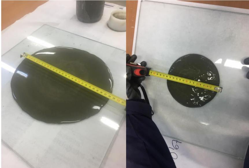
FIGURA 5. 5: ENSAYO DE ESCURRIMIENTO PARA MEZCLAS 1/1 Y 0,67/1
