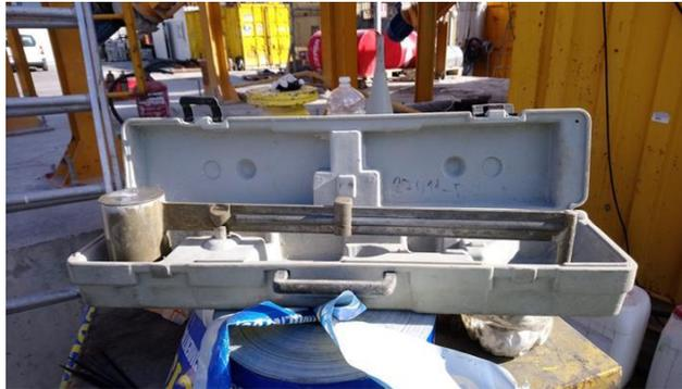
FIGURA 6. 5: BALANZA DE LODOS
