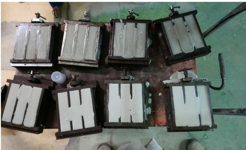
FIGURA 6. 3 PROBETAS FABRICADAS CON EL 70% Y EL 90% DE ESCORIAS
