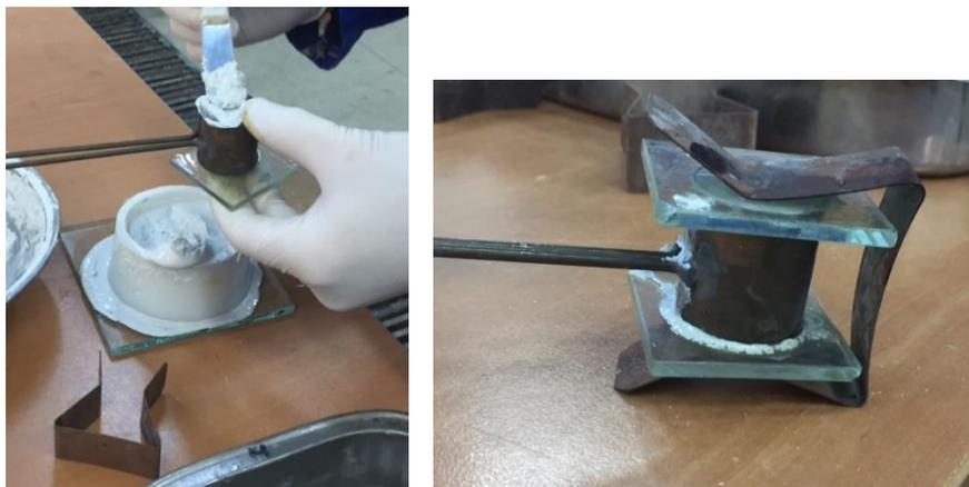
FIGURA 5. 15: PREPARACIÓN DE LA MUESTRA EN EL ENSAYO DE LE CHATELIER
