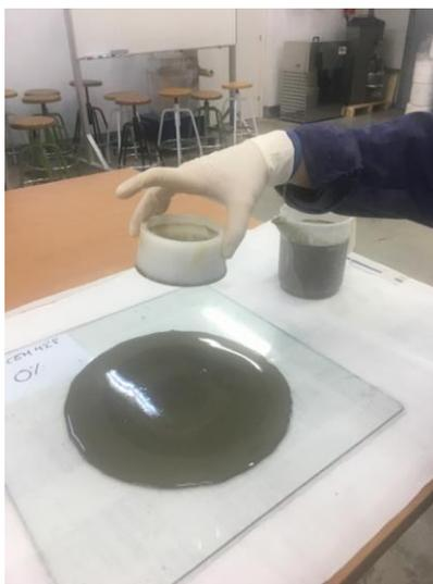
FIGURA 5. 4: ENSAYO ESCURRIMIENTO DE LA LECHADA
