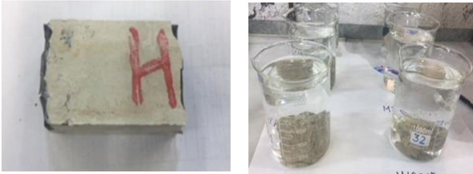
FIGURA 5. 17: PROBETAS DE LIXIVIADO (A) PROBETA ANTES DE SER INTRODUCIDA EN AGUA DESTILADA
