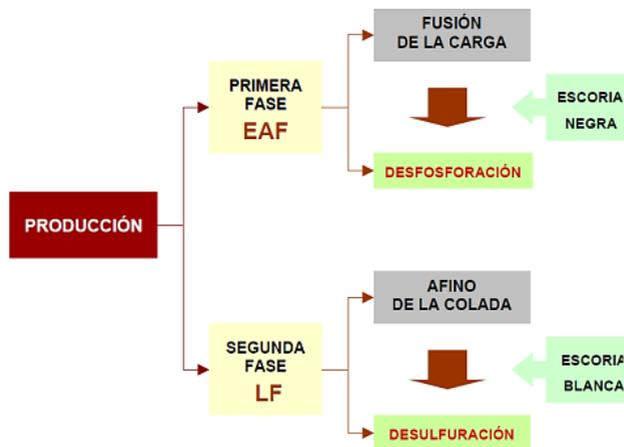
FIGURA 2. 9: PROCESO DE FABRICACIÓN DE ACERO CON HORNOS DE EAF-LF
