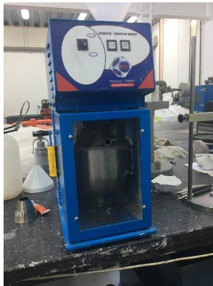
FIGURA 3. 9: MEZCLADOR DE LABORATORIO PARA LECHADAS CEMENTOSAS
