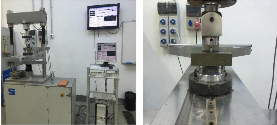
FIGURA 4. 10: ENSAYOS DE ROTURA A FLEXIÓN.
