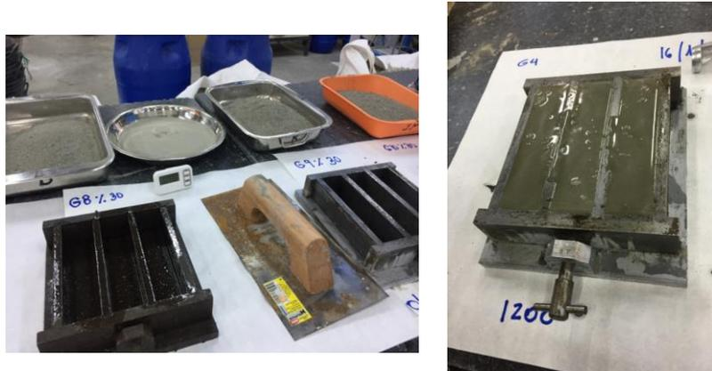
FIGURA 3. 10: PREPARACIÓN DE MOLDES Y MOLDE LLENO
