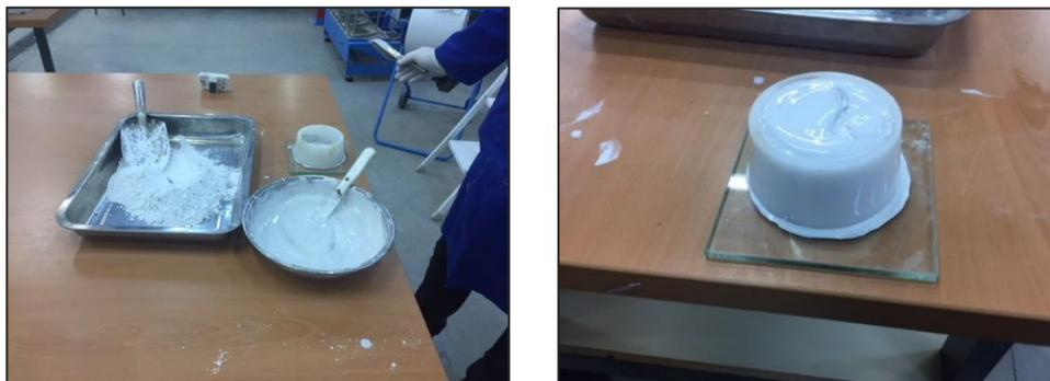
FIGURA 5. 13 PREPARACIÓN DE LA PASTA AGUA/ESCORIA DE CONSISTENCIA NORMAL
