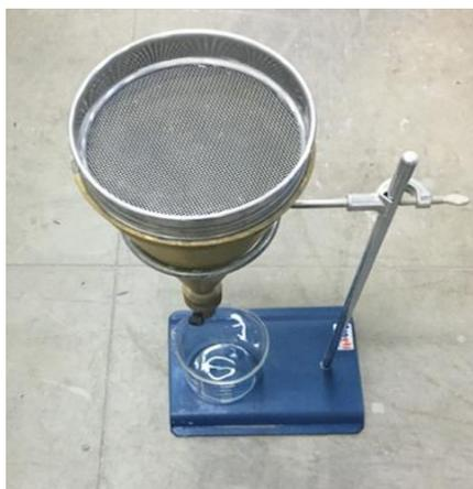
FIGURA 4. 1: ENSAYO GRANULOMÉTRICO MEDIANTE TAMIZADO
