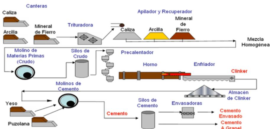
FIGURA 2. 5: PROCESO DE FABRICACIÓN DEL CEMENTO
