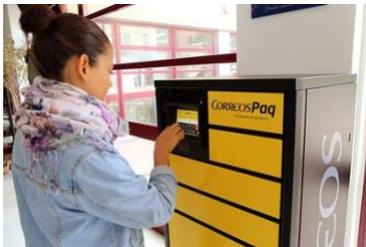
Los terminales *CityPag* ofrecen a los usuarios la posibilidad de tener acceso a sus paquetes durante todas las horas de apertura del lugar donde estén ubicados. Los terminales instalados disponen de 6 compartimentos de diferentes medidas adaptables al volumen de los paquetes y, además, cuentan con todos los requisitos de seguridad y accesibilidad pues están adaptados, por disposición y altura, para su uso por personas con discapacidad.
