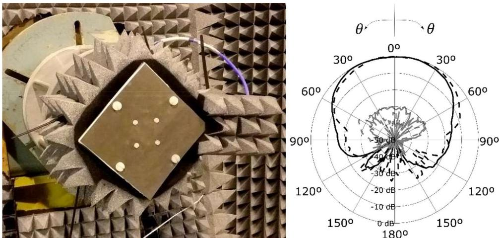
**Figura:** Antena “microstrip” de banda ancha en la cámara anecoica del Grupo de Microondas de la Universidad de Sevilla, y su diagrama de radiación en plano E medido (línea continua) y simulado (líneas discontinua) a 5.75 GHz.
