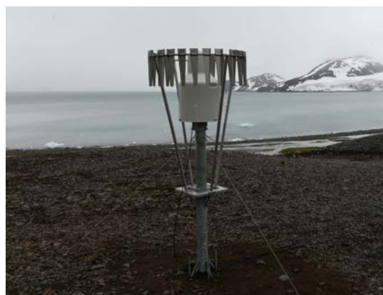
Pluviómetro de pesada en la base Juan Carlos I
