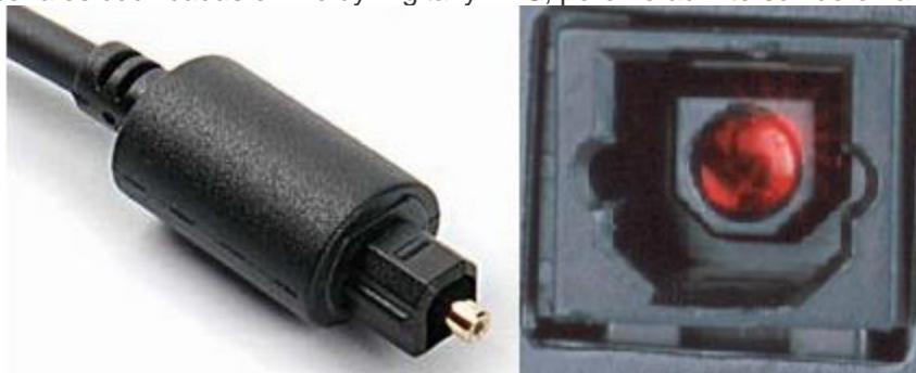
Imagen de cable óptico TOS-link y detalle de la conexión, en el que se puede observar el led que emite la señal óptica.
