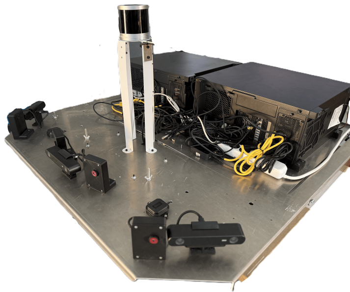
Figura 4.5: Vista lateral de la plataforma metálica con los sensores y sus soportes.
