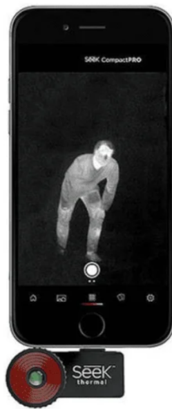
Figura 2.6: Ejemplo de imagen térmica típica obtenida con esta cámara [20].
