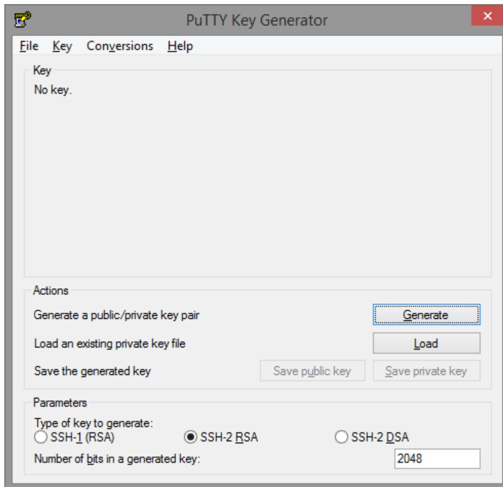
2. Pulse el botón 'Generate'. Se le pedirá que mueva el ratón de forma aleatoria por la zona que hay bajo la barra de progreso. Conforme vaya moviendo el ratón se indicará el progreso del proceso.
