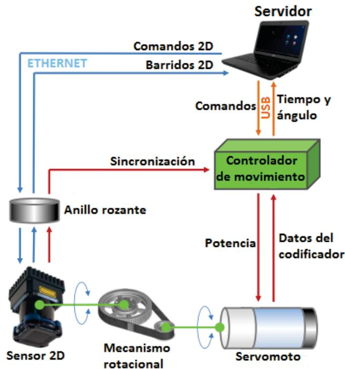
Figura 5.7: Diagrama funcional del sensor láser 3D.
