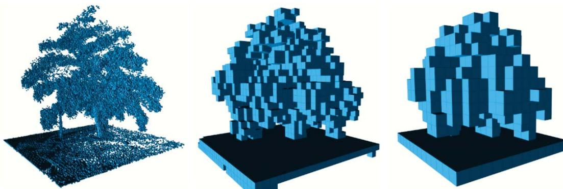
Figura 3.3: Entorno representado a diferentes profundidades de la estructura para mostrar la multi-resolución.
