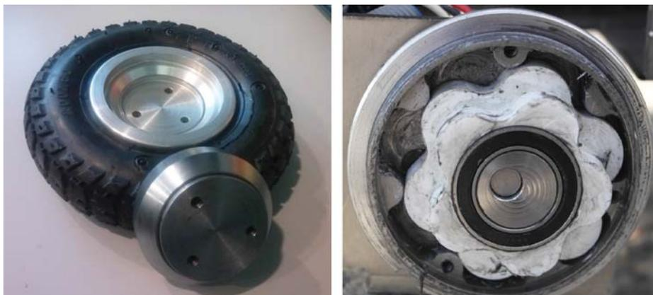
Figura 4.2: La rueda y la tapa de la reductora a la izquierda y la reductora epicycloidal a la derecha.
