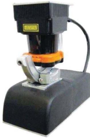
Figura 5.5: Telémetro láser 3D UNO-Laser.
