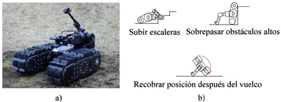
**Figura 21 a) Robot Helios IX. b) Robots Helios realizando operaciones con el brazo en contacto con el suelo.**
