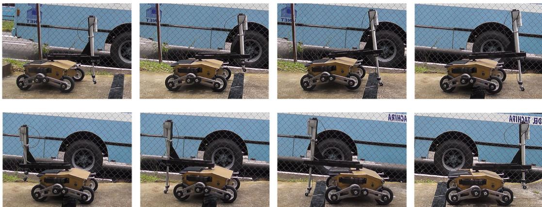
Figura 106. Secuencia seguida por Lázaro para sobrepasar una zanja.
