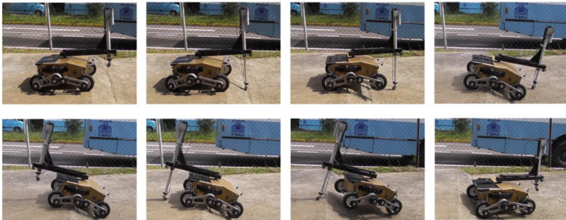
**Figura 98. Secuencia seguida por Lázaró para el descenso sobre una rampa.**
