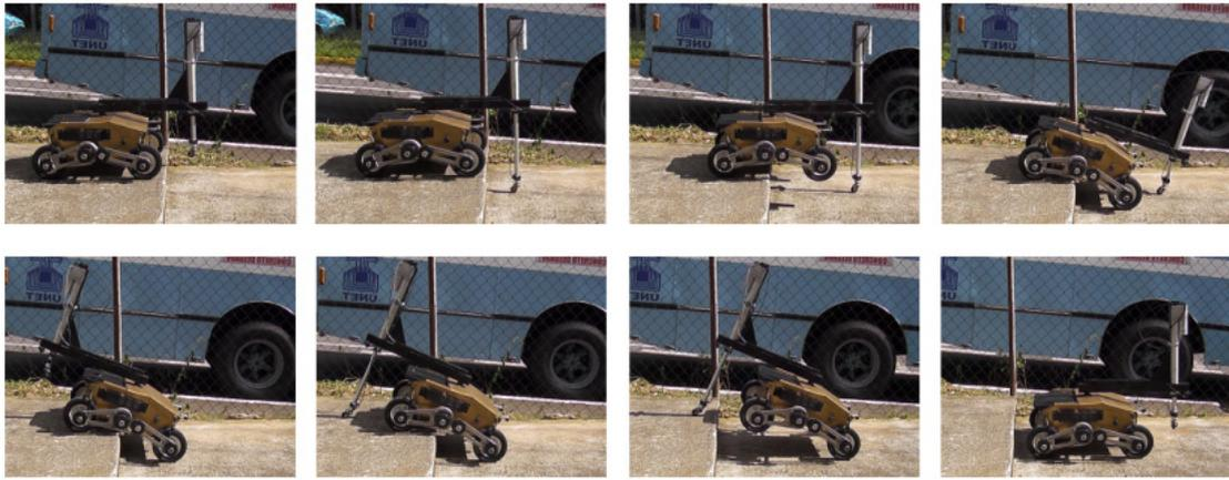
**Figura 97. Secuencia seguida por Lázaró para el descenso sobre un escalón.**
