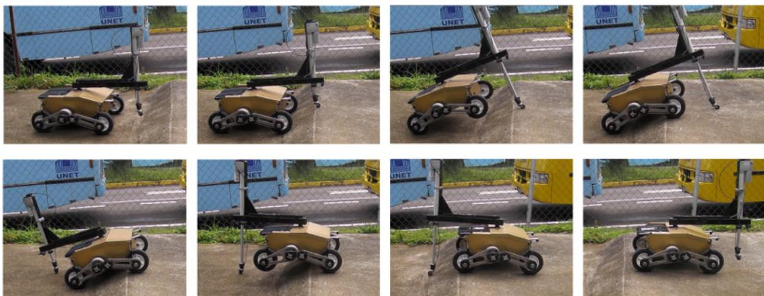
Figura 85. Secuencia seguida por Lázaró para el ascenso sobre una rampa.
