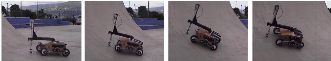
**Figura 58.** Secuencia seguida por Lázaro durante un ascenso con *roll* y *pitch* variables.
