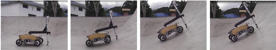
**Figura 56. Secuencia seguida por el robot Lázaro durante un ascenso con *pitch* variable y  $\alpha = 0$ .**
