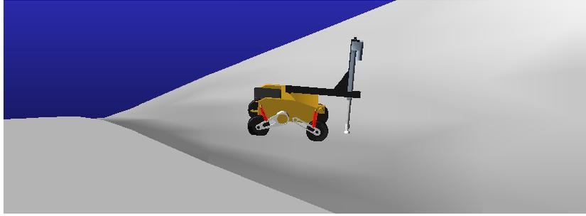
**Figura 54.** Robot Lázaro desplazándose sobre una superficie de pruebas con ángulo *roll* variable.
