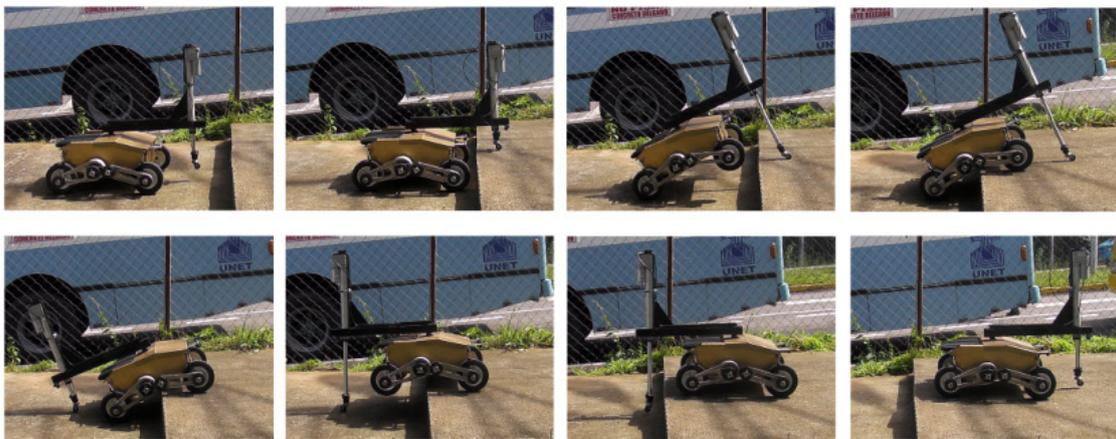
Figura 84. Secuencia seguida por Lázaró para el ascenso sobre un escalón.
