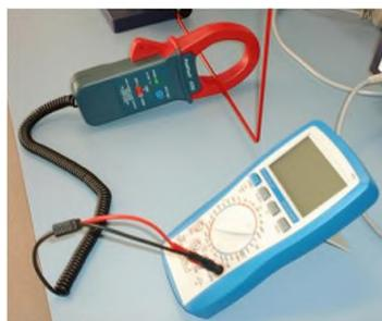
Figura 3.- Sistema medidor de corriente formado por sonda-pinza + voltímetro.
