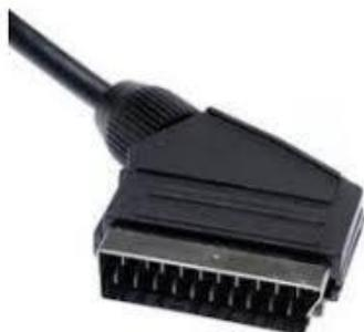
Este conector analógico, también conocido como *SCART*, conecta dos dispositivos, por ejemplo, un televisor y un DVD, mediante un sólo cable, que transmite tanto video como audio estéreo. Tiene 21 pines y es bidireccional (puede enviar y/o recibir información).
