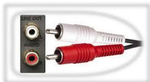
Es un tipo de conector analógico que utiliza canales de audio separados estéreo (izquierdo y derecho), bien diferenciados en dos cables, normalmente uno con un conector de color rojo, generalmente el derecho, y otro de color negro o blanco para el izquierdo. Se puede utilizar solamente uno de los canales lo que dará lugar a una señal mono. Se utiliza para todo tipo de dispositivos, sobre todo si se necesita separar la señal en dos canales bien
