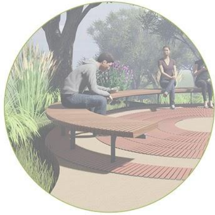
BANCOS / La geometría es la misma siempre, solo que cuando se apoya en el muro surge un respaldo, y cuando no levita. Con la sección de una pieza se conforma radialmente cualquier banco. Están geometrizado en un radio de 2,40 m
